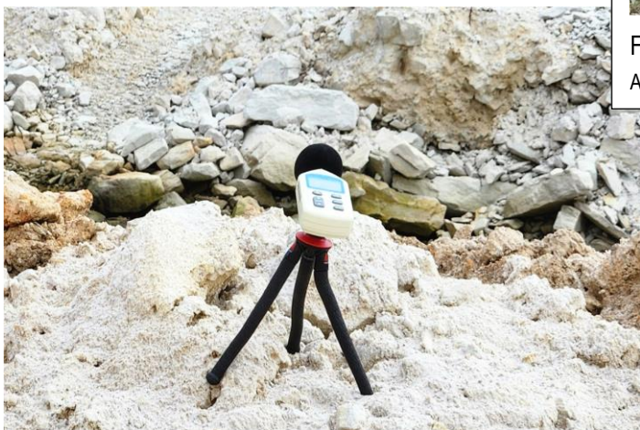
Figura 10: Decibelímetro realizando leitura. Autor Iuri Bayerl 26_mar_2025
